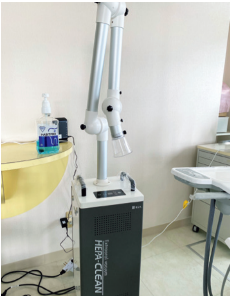
BSA社製のヘパクリン：歯牙削合や歯石除去の際に診療室内に飛散する飛沫を吸引しHEPAフィルターによって集塵する機器
