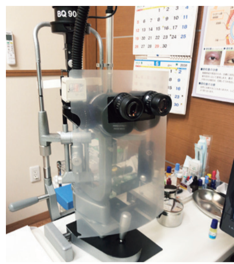
著者作成の細隙灯顕微鏡用シールド。眼科の診察で使われる細隙灯顕微鏡に取り付けて診察時の飛沫感染を防ぎます
